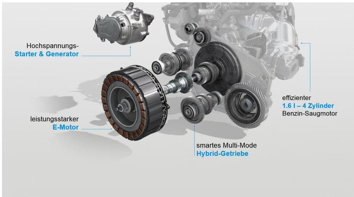
Hinzu kommen zwei Elektromotoren und ein Multi-Mode-Zahnradgetriebe mit Schaltmuffen (ohne Kupplung). Bei einem der beiden Elektromotoren handelt es sich um einen sogenannten **HSG Hochspannungs-Starter (High-Voltage Starter Generator)**. Die Koppelung der Elektromotoren mit dem innovativen Getriebe ermöglicht optimierte, sanfte Schaltvorgänge. Die Architektur maximiert zudem den energetischen Wirkungsgrad.
