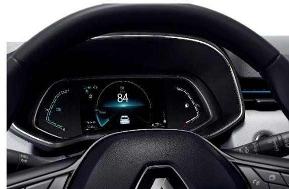
Das « Smart Cockpit » beinhaltet die digitale 7-Zoll-Instrumentenanzeige und das neue Multimedia-System Renault EASY LINK, wahlweise mit horizontalem 7-Zoll- oder vertikal angeordnetem 9,3-Zoll-Monitor. Spezifische Hybrid-Anzeigen wie beispielsweise der Ladezustand der Batterie oder die Aktivität des Elektromotors sind über das digitale Instrumentenbrett abrufbar.
