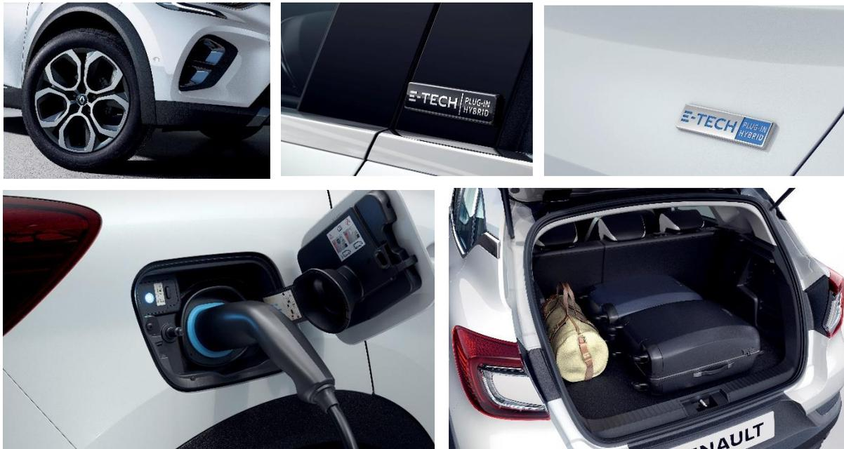
Das Platzangebot im Fahrzeuginnen bleibt unverändert und die Rücksitzbank lässt sich nach wie vor um 16 cm in Längsrichtung verschieben. Ein Stauraum unter der abnehmbaren Bodenabdeckung im Kofferraum bietet Platz für das Ladekabel, ohne das Kofferraumvolumen zu beeinträchtigen.
