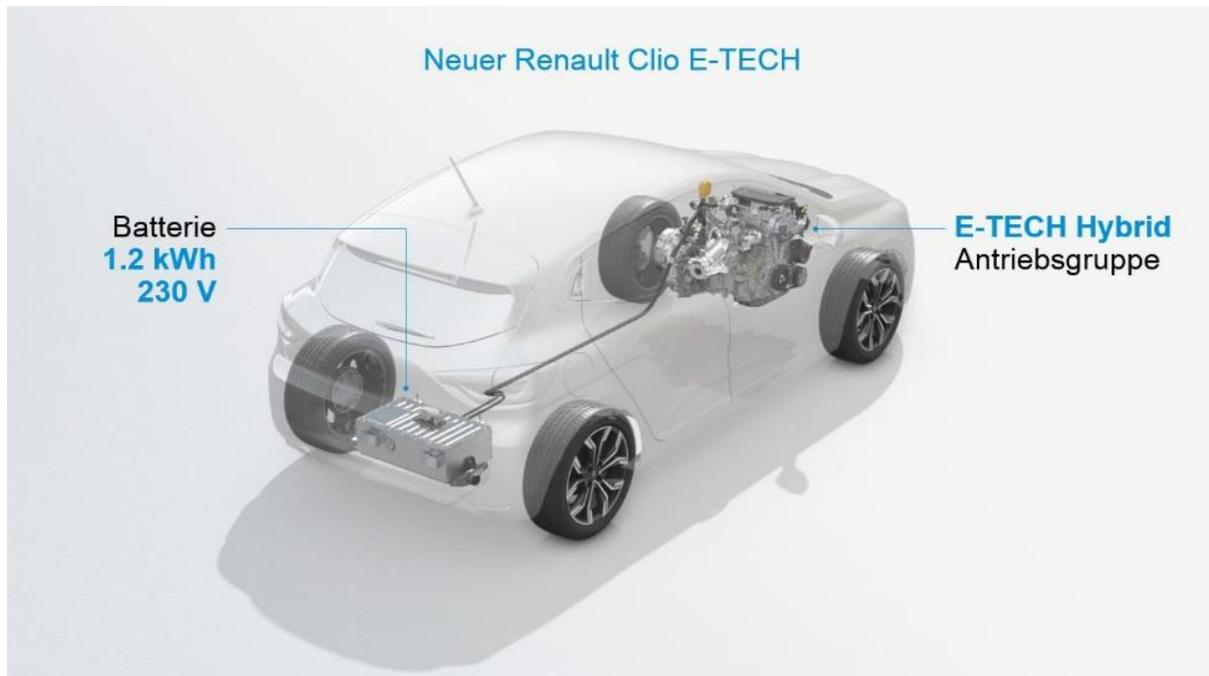
Das regenerative Bremsen - wie bei einem Elektrofahrzeug - in Verbindung mit der hohen Batterieladepkapazität und Effizienz des E-TECH-Systems trägt zur Energieoptimierung bei. Tatsächlich werden 80 % der Zeit im Stadtverkehr rein elektrisch zurückgelegt, was einer Verbrauchsreduktion von bis zu 40 % gegenüber Verbrennungsmotoren bedeutet. Im vollelektrischen Betrieb kann der Neue Clio bis zu 70-75 km/h fahren.
